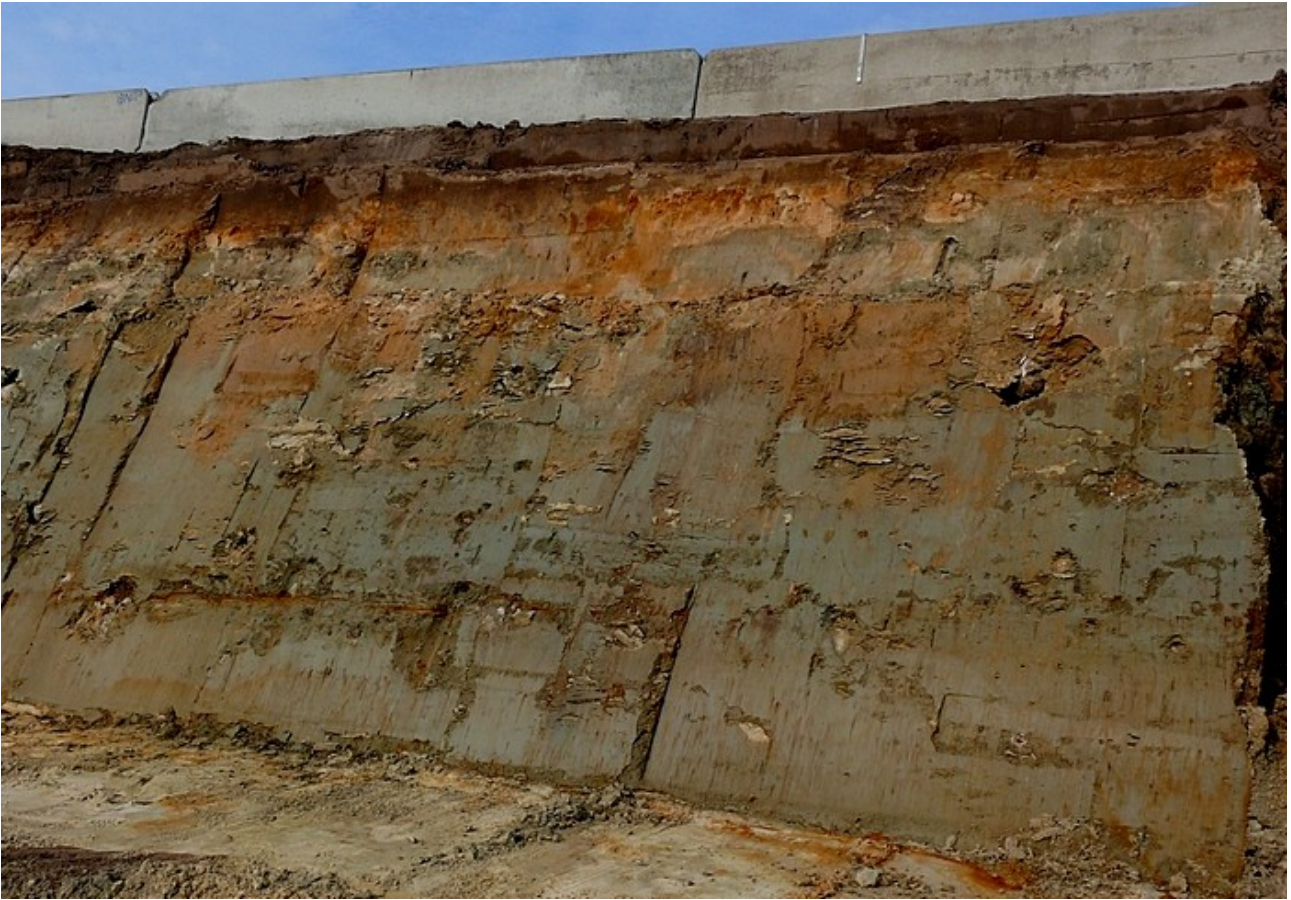
Figuur 8.4.1. Eelde, Grootte Veen. Keilemafzetting op de kruising N33/N34 bij Gieten. De keilemafzetting is ruim 4 meter dik. De zwerfsteininhoud is Oostbaltisch net als in Eelde op de locatie het Grootte Veen. De kleuren van de leemlaag zijn te danken aan reductie (blauwgrijs) en oxidatie (roestbruin).
